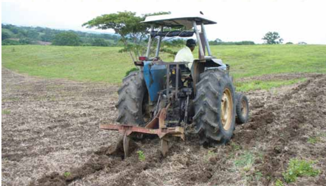
Foto 20. En suelos compactados asegúrese que el cincel penetre al menos 40 centímetros.
