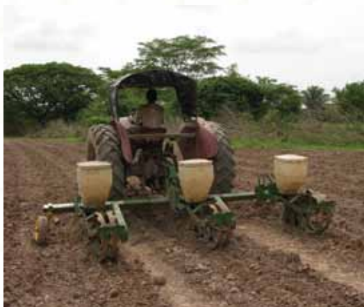
Foto 25. Las sembradoras de maíz o sorgo son eficientes para la siembra de leucaena en sistemas silvopastoriles intensivos. Hacienda Guadalajara, Codazzi, Cesar.
